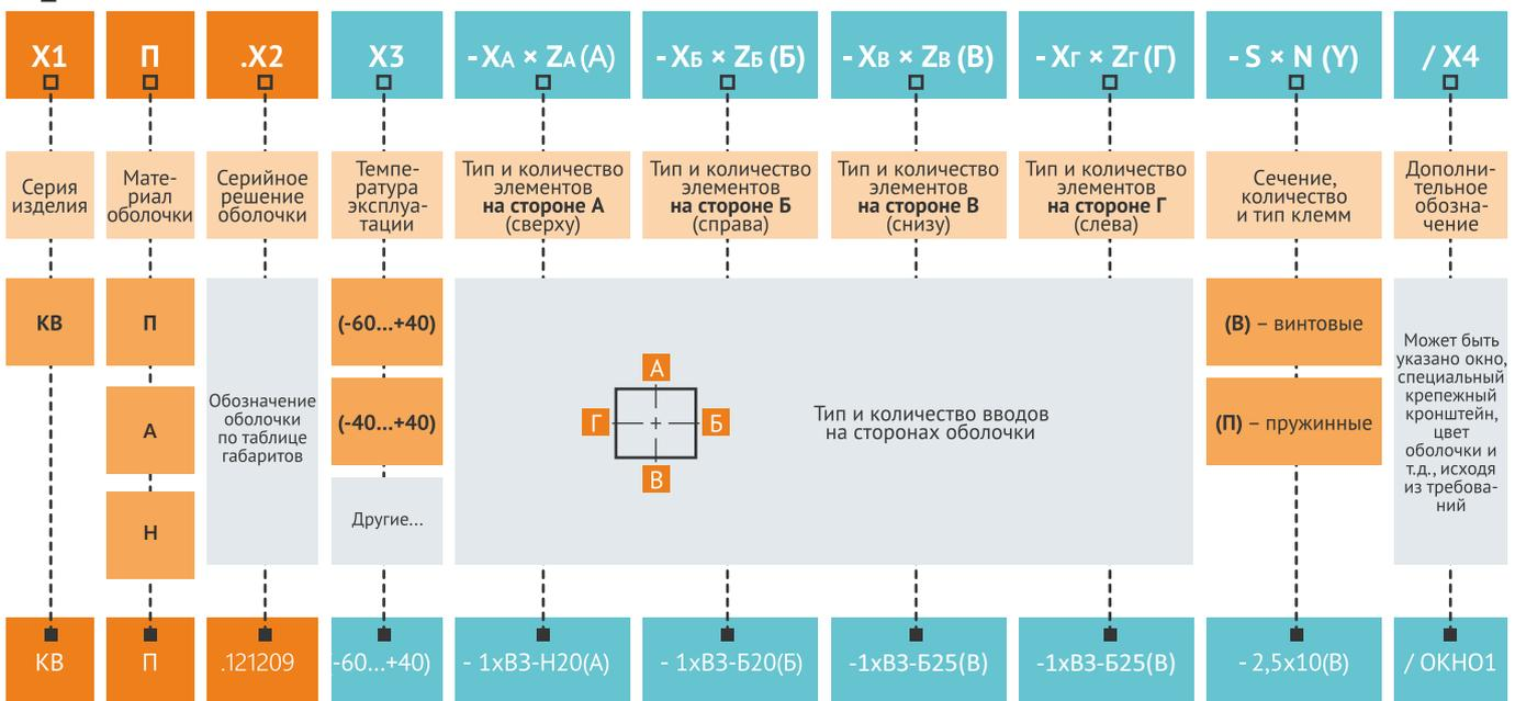
КВП.121209 (-60...+60)-1xВ3-Р25П(Г)-1xВ3-40/КР(В)-10,0x3(В)+10,0x2PE(В) 123x123x90 мм, 1Ех е IIC Т3,Т6 Gb, IP66
